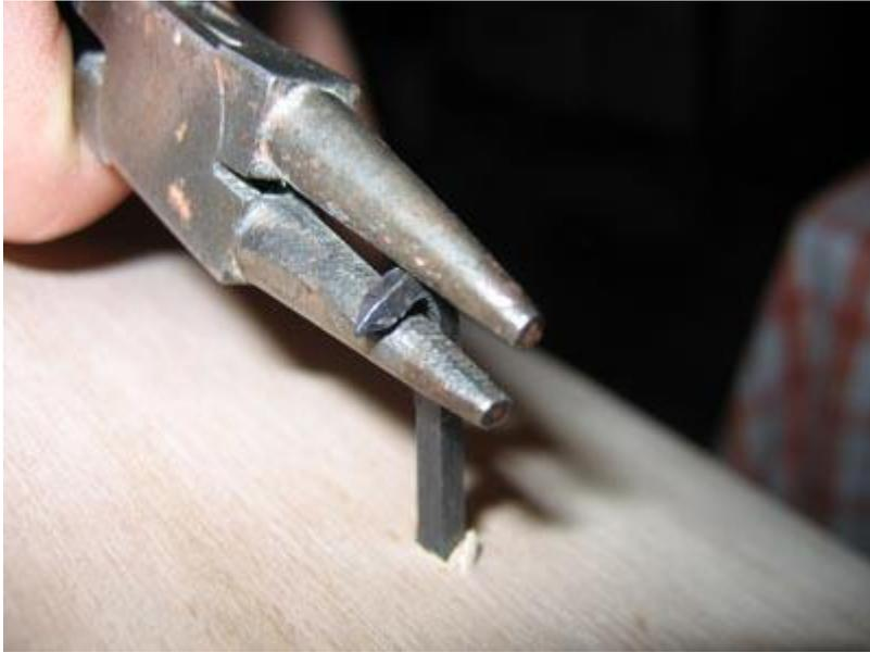
Danach setzt man ganz unten am Nagel einen Schraubenzieher an und winkelt den Nagel eng am Schild ab. Dann so lange drauf rumhämmern bis der Nagel wieder ins Holz eindringt.
